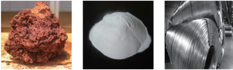
圖1、鋁土礦、氧化鋁和鋁棒
