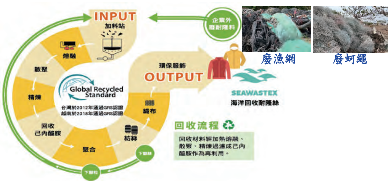
圖5、回收廢漁網、廢蚵繩再製為環保絲流程圖
